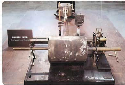
大森式地震計(1910～1980年に使用) それまでは、地震動を感知してから機械が作動したた め、初動部分を記録することができなかったが、世界 で初めて連続24時間記録ができるようになった
