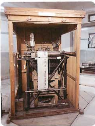
ウィーヘルト地震計 (1932～1991年に使用) 地震観測史・地震学における初 めての本学的な精密計測機器 と位置づけられている。機械式 地震計の最高傑作とのこと
