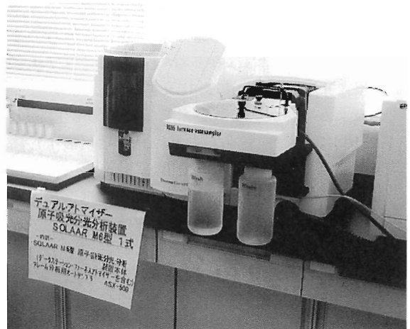
デュアルアトマイザー原子吸光分光分析装置 SOLAAR M6
