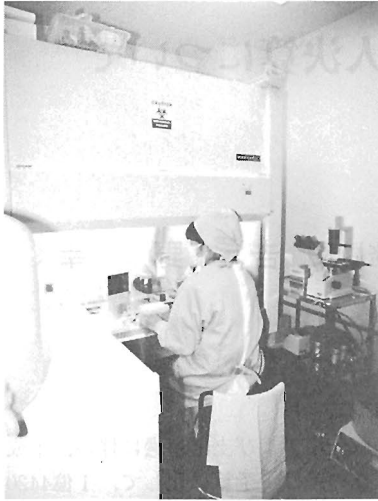
写真3. 安全キャビネット
